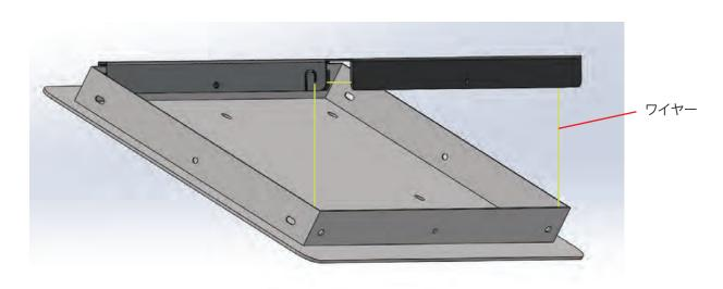
4. この状態で、灯具を吊り下げ一旦固定します。コードをガラスに通し天板の上部にコード ストッパーで固定してください。使用しているコードは非常にデリケートです。 ※このとき吊り高さを長めに設定してください。
